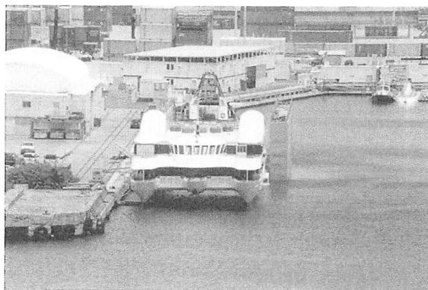
ハワイのデイクルーズ船「ナバテック」SWATH型のユニークな船
